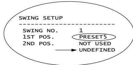
스윙 운전은 먼저 **1st Position** → **2nd Position** 으로 시계방향(ClockWise)으로 이동한 후, **2nd Position** → **1st Position** 으로 반시계방향(Count-ClockWise)으로 이동합니다.
