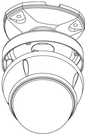
④ 고정 나사를 이용하여 설치를 완료하고 돔 커버 보호용 비닐을 제거합니다.
