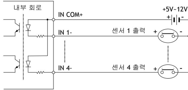
센서를 결선하기 전에 센서의 구동 전압과, 센서의 신호 출력 방식을 체크하십시오. 센서의 신호 출력 방식은 크게 **Open Collector** 방식과 **Voltage Output** 방식이 있으므로, 각각의 경우에 맞게 결선하여야 합니다.
